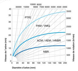
Les bagues d'étanchéité intégrant une lèvre additionnelle de protection sont limitées à une vitesse de 8 m/s.
